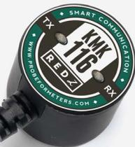
La sonda óptica REDZ KMK116 está diseñada de acuerdo con el estándar IEC 62056-21 y es compatible con todas las marcas y tipos de contadores IEC. La sonda tiene un conector USB macho Tipo-A, así que puede usarse fácilmente con ordenadores portátiles y otros dispositivos compatibles.
