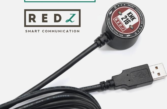
La sonda óptica REDZ KMK 216 avanzada está diseñada de acuerdo con el estándar IEC 62056-21 y es compatible con todas las marcas y tipos de contadores IEC. La sonda tiene un conector USB macho Tipo-A, así que puede usarse fácilmente con ordenadores portátiles y otros dispositivos compatibles. Tiene un diseño mínimo para facilitar su uso, filtro de luz diurna para una mejor transmisión de datos y una estructura mejorada de la carrocería y el cable para que se puedan utilizar durante muchos años.
