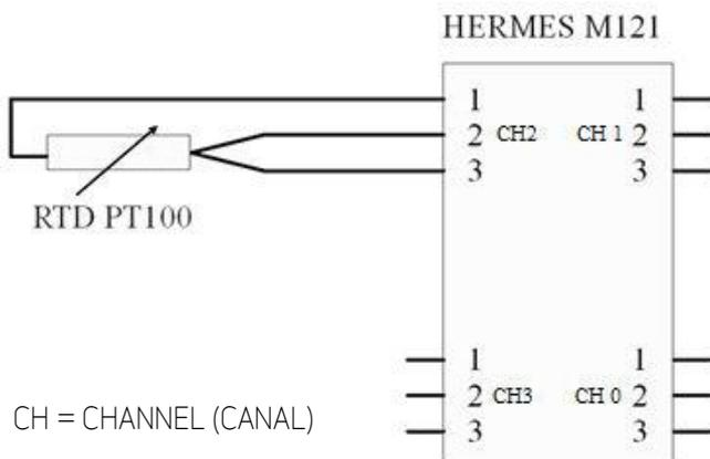
Debe evitarse la instalación de los cables de las sondas junto a cables de potencia para evitar perturbaciones magnéticas que pueden afectar a la precisión de las medidas. Se recomienda el uso de cable apantallado.
