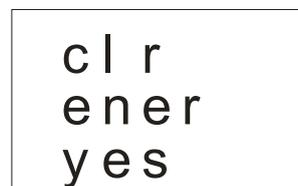
Figura 45 . Borrado de contadores de Energía
