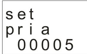
Figura 32 . Relación del primario de corriente
