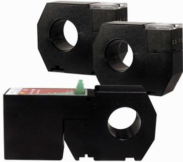
El Power Net es un analizador que mide, calcula y visualiza a través de un master u ordenador con software POWER STUDIO, los principales parámetros eléctricos en redes industriales trifásicas (equilibradas o desequilibradas). La medida se realiza en verdadero valor eficaz, mediante tres entradas de tensión Vca. y la intensidad se mide mediante transformadores tipo TC-Power Net. Los parámetros medidos se muestran en la tabla de variables medidas.
